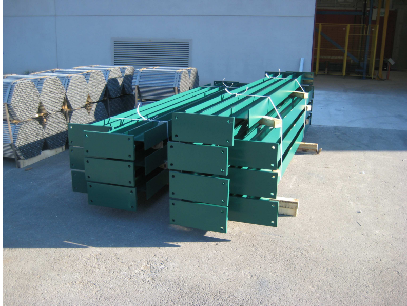
Figura 7. Estructuras para pantallas (dúplex)
