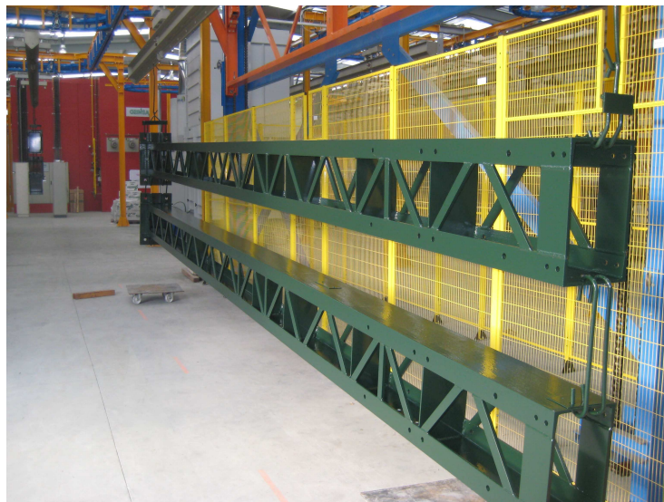
Figura 8. Estructura para catenaria ferroviaria (dúplex)
